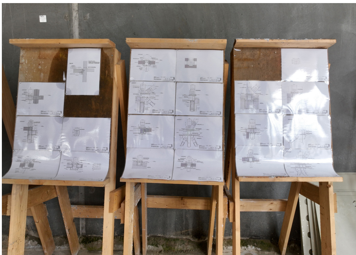
Tavler. På etagerne er opsat tavler, hvor tømrerne kan se, hvordan alle elementer skal samles og med hvilke skruer. Foto: DTU
